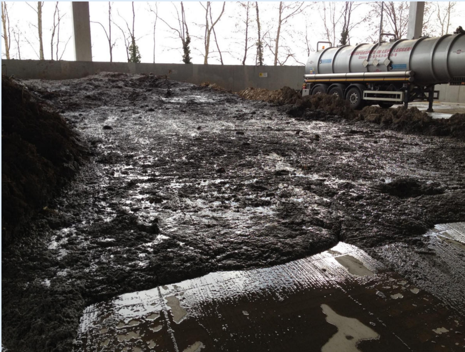
Scarico in impianto (stato fangoso non palabile)
