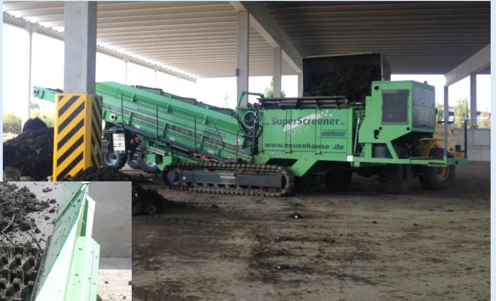
Vagliatura dimensionale primaria attuata con vaglio stellare
