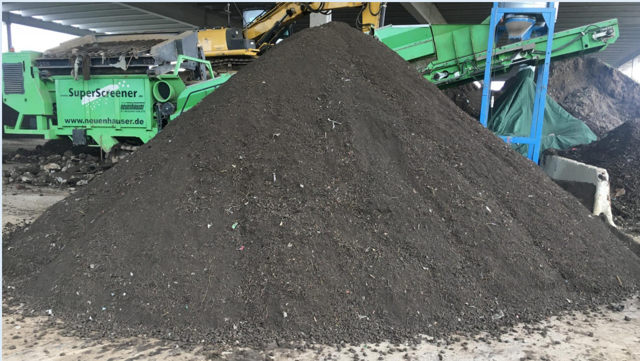
Sottovaglio da vagliatura dimensionale primaria idoneo per l'avvio al processo di risanamento biologico
