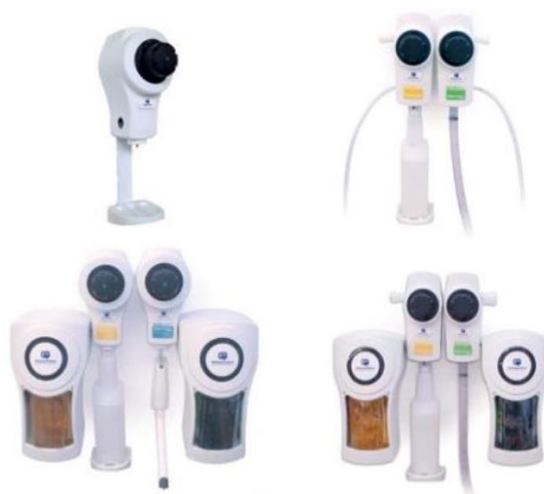
Figura 1. Esempi di dispositivi per la diluizione e il dosaggio. A sinistra: Miscelatore proporzionale; diluisce un quantitativo controllato di prodotto di pulizia con acqua quando è collegato al rubinetto (ottenendo una soluzione pronta per l'uso). A destra: Sistemi di dosaggio manuale che erogano uno specifico quantitativo di prodotto concentrato in un secchio, un lavello o un contenitore a spruzzo.
