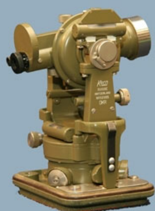
TACHEOMETRO AUTORIDUTTORE "KERN" (Svizzera) mod. DKM2 anno 1964
