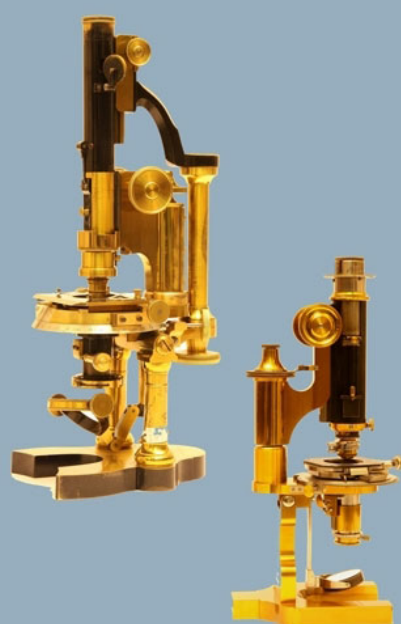
R. FUESS BERLIN STEGLITZ microscopi o petrografico-mineralogico utilizzato anche nelle campagne d'Africa periodo 1900-1930 2 esemplari
