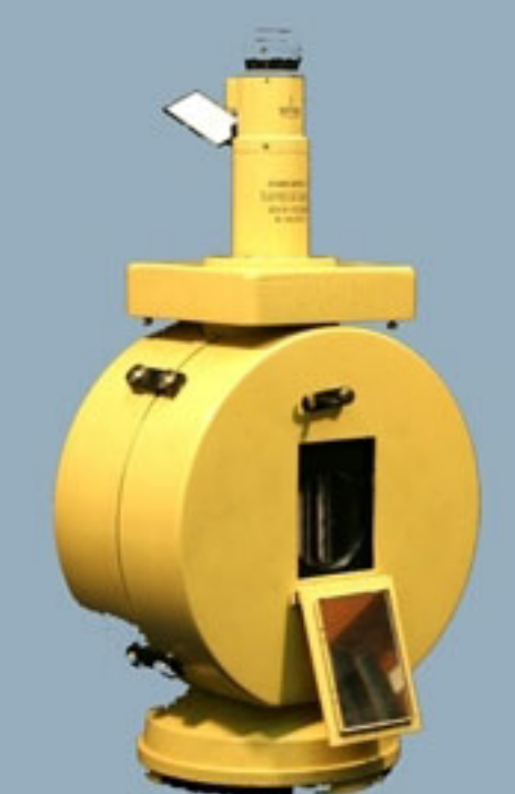
BILANCIAMAGNETICA DI SCHMIDT - mod. GF6 ASKANIA-WERKE - Germania - anno 1943
