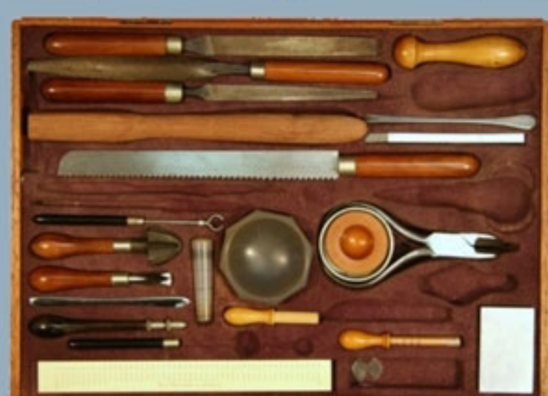
REAGENTARIO DA CAMPAGNA attrezzi per effettuare la preparazione meccanica dei campioni e l'analisi a caldo e saggi alla fiamma anno 1885-1890 (Germania)
