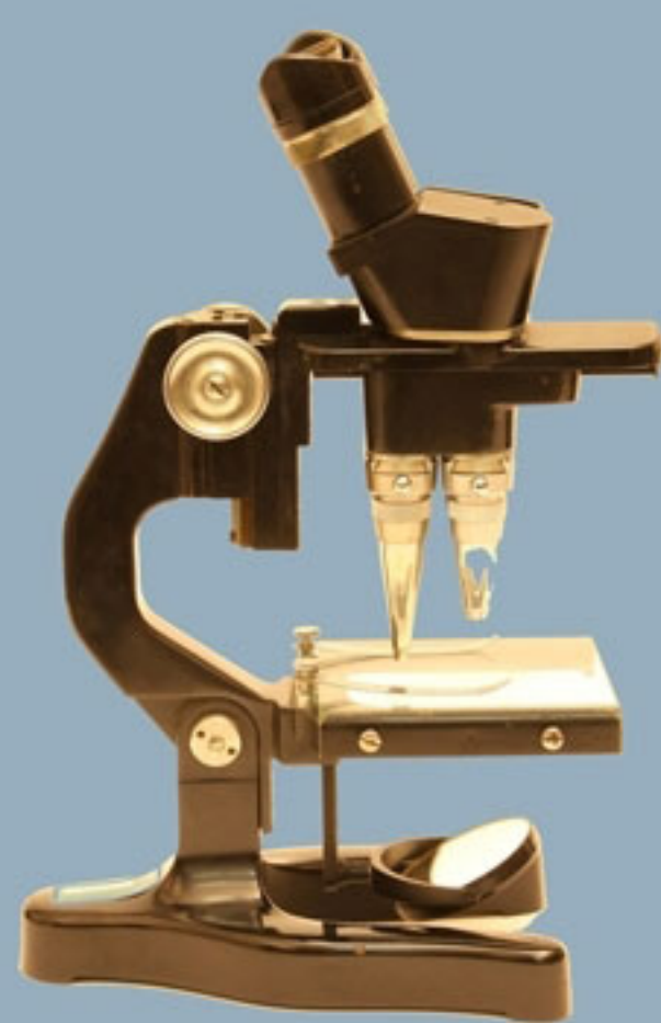
LEITZ - WTZLAR microscopio per micropaleontologia ed esami microgranulometrici di sabbie. cambio degli obiettivi a scorrimento lineare. anno 1950
