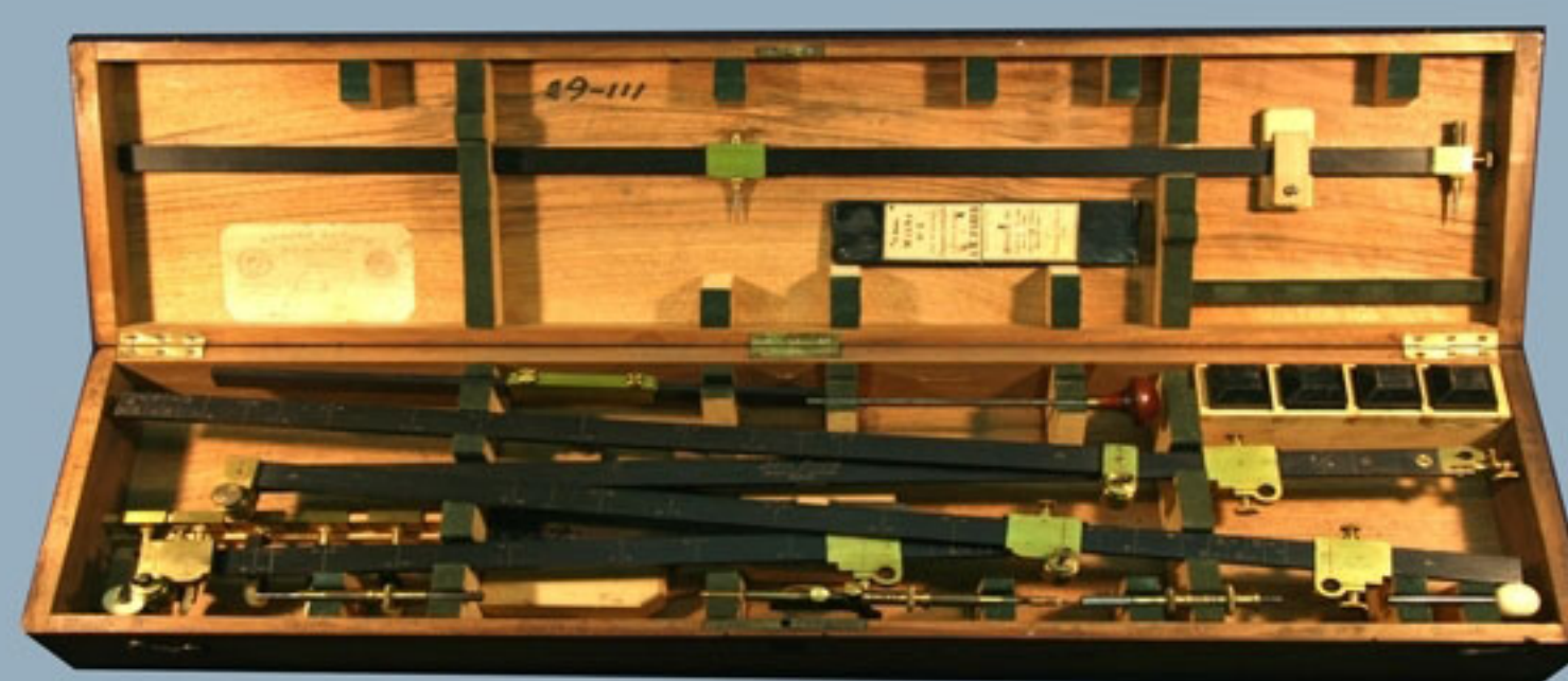
PANTOGRAFHE CARRE' pantografo per copiare disegni in scala anno 1890-1900
