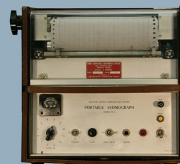
SISMOGRAFO PORTATILE MONOCANALE HUNTING SURVEY - USA mod. FS-2 anno 1961
