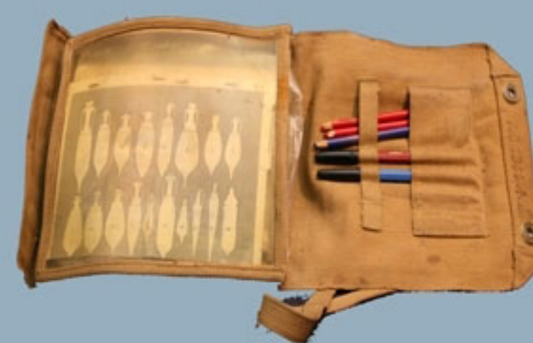
TASCAPANE permetteva la consultazione speditiva di documenti in ambiente subacqueo, e la possibilità di scrittura con matite vetrografiche periodo 1968-1974
