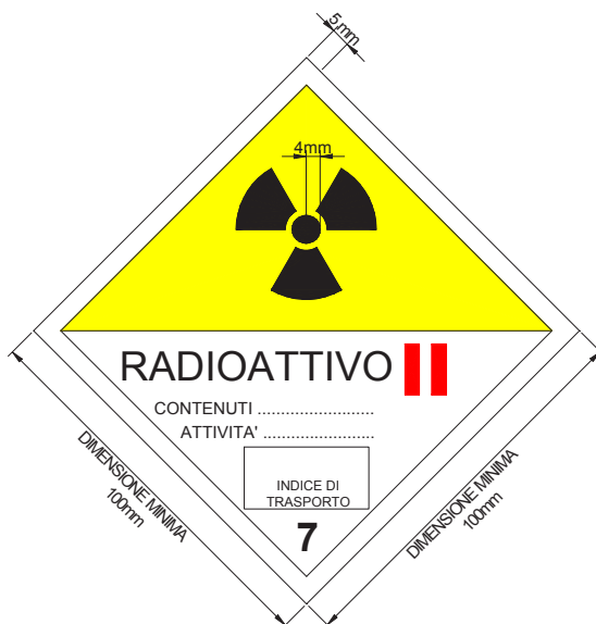
FIG.3 Etichetta della categoria II-GIALLA. Il colore di fondo della metà superiore dell'etichetta deve essere giallo e della metà inferiore bianco, il colore del trifoglio e delle scritte deve essere nero ed il colore delle barre indicanti la categoria deve essere rosso.
