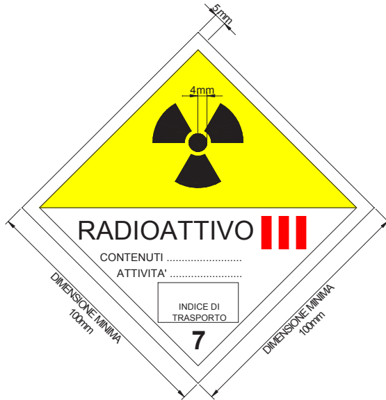
FIG. 4 Etichetta della categoria III-GIALLA. Il colore di fondo della metà superiore dell'etichetta deve essere giallo e della metà inferiore bianco, il colore del trifoglio e delle scritte deve essere nero ed il colore delle barre indicanti la categoria deve essere rosso.
