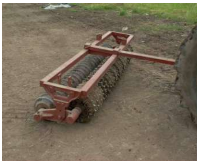
Foto 56 - Metanodotto Bordano – Flaibano (UD) loc. Piani di Osoppo, Particolare del rullo frangizolle - Foto Snam Rete Gas, 2004
