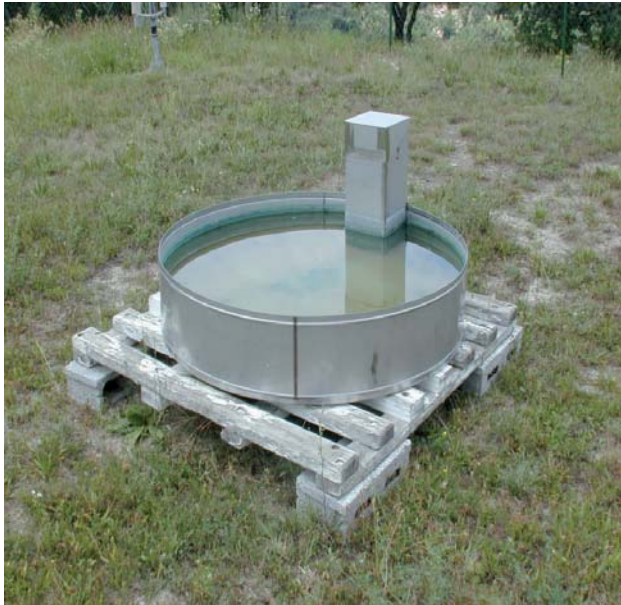
Fig. 33 - Evaporimetro con vasca sopraelevata
