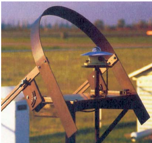
Fig. 27 - Piranografo per la misura della radiazione solare diffusa
