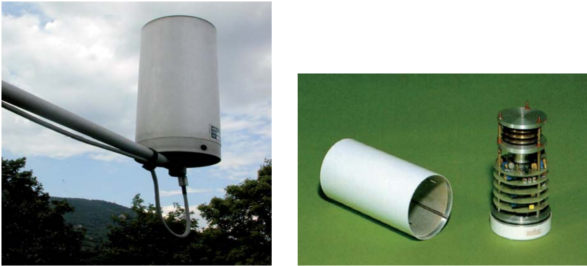
Fig. 17 - Barografo moderno e suoi elementi
