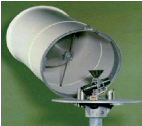
Fig. 7 - Immagine dell'interno di un pluviometro
