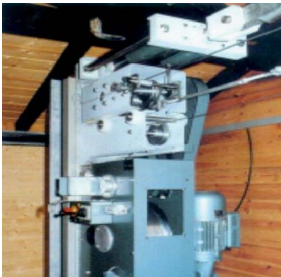
Fig. 49 - Argano di una teleferica
