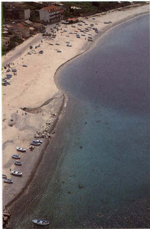
Fig. 111. – Frana subacquea di Catona in provincia di Reggio Calabria, 17 giugno 1987. Si nota la nicchia di distacco e l'antistante porzione di mare più scuro corrispondente alla zona di allontanamento del materiale (fotografia dell'autore).
