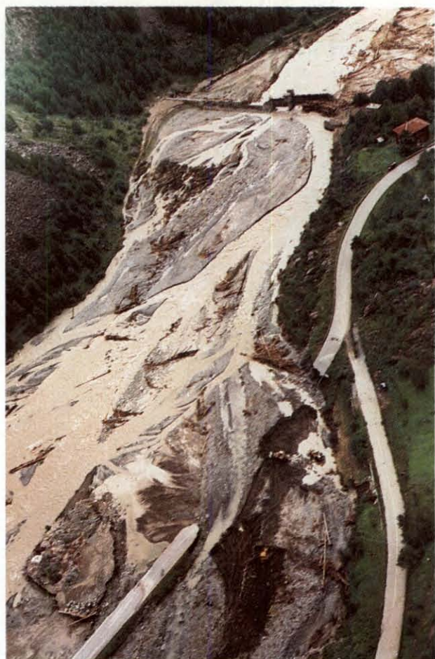
Fig. 17. – Valtellina, provincia di Sondrio. F. Adda presso località Ponte di Ferro. Asportazione di un tratto della SS. n. 38, 17-19 luglio 1987 ( fotografia dell'autore ).
