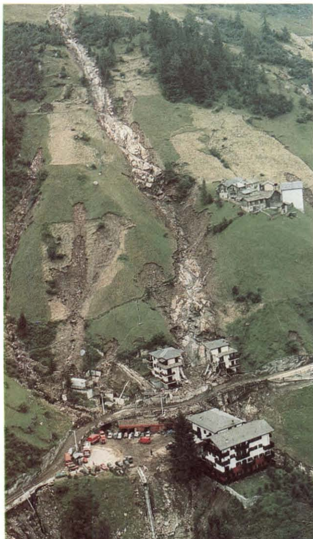
Fig. 24. – Valtellina, provincia di Sondrio. Frana di Valle Tartano, 17 luglio 1987, una delle tante innescate per saturazione e fluidificazione dei materiali sciolti costituenti la copertura superficiale, con scorrimenti che evolvono rapidamente in colate per lo più incanalate entro linee di drenaggio (fotografia dell'autore).
