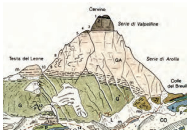
Fig. 16 - Geologia del Cervino, versante italiano (DAL PIAZ, 1992, 1996b). Falda della Dent Blanche s.l., lembo del Cervino: Serie di Valpelline: complesso kinzigitico; Serie di Arolla: gneiss granitoidi (GA); gabbro permiano (G) con filoni acidi e basici (F), miloniti (m), micascisti del Colle del Breuil (mc). Zona del Combin, alla base: calcescisti mesozoici (c); metabasalti prasinitici (p). 1-12: dettagli della descrizione geologica della via italiana al Cervino in DAL PIAZ (1996b).
