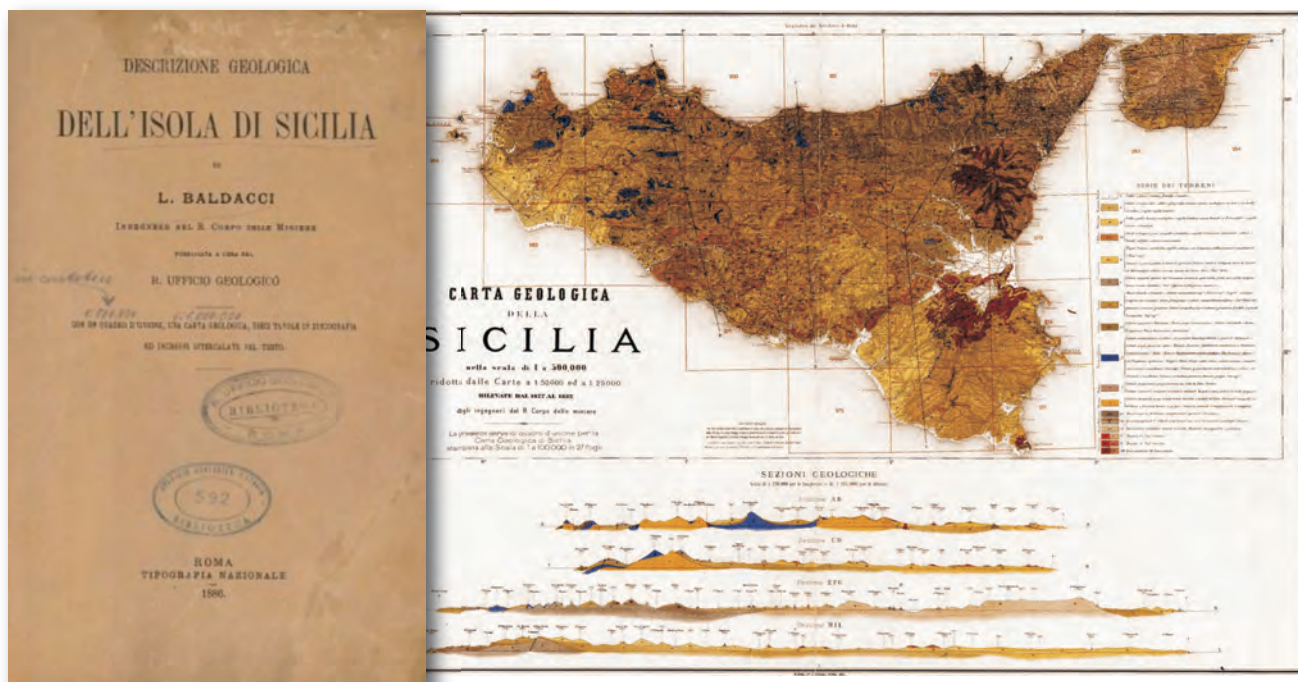
Fig. 4 - La copertina del volume 1 che contiene allegata la "Carta geologica della Sicilia nella scala 1 a 500.000 ridotta dalle Carte a 1:50.000 e 1:25.000 rilevate dal 1877 al 1882 dagli ingegneri del Regio Corpo delle Miniere", comprende 4 sezioni geologiche alla scala 1:250.000 per le altezze, la presente serve di quadro d'unione per la Carta Geologica della Sicilia, stampata alla scala 1:100.000 in 27 fogli.
