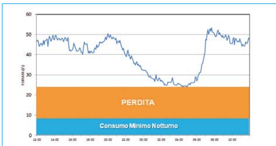
Figura 1 - Calcolo della perdita con il metodo del Minimo Notturmo. La perdita è data dalla differenza tra la portata del distretto (misurata) e il Consumo Minimo Notturmo degli utenti (stimato)
