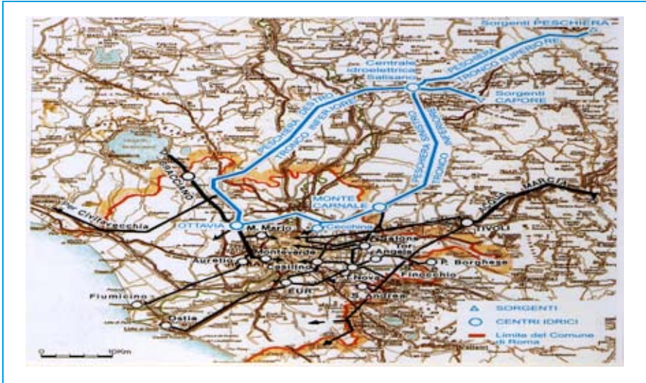
Figura 2 - Sistema di smistamento e centri di distribuzione idrica
