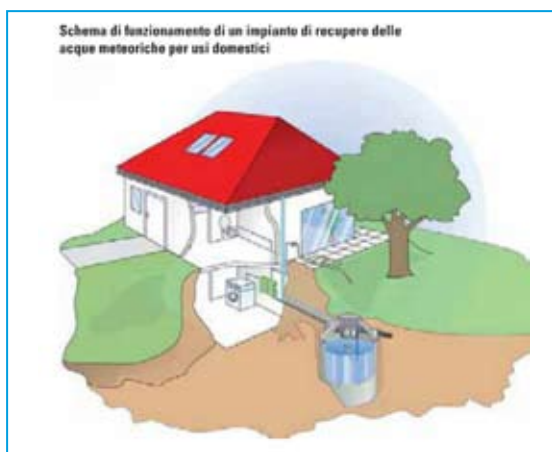
Figura 1 - Schema di funzionamento di un impianto di recupero delle acque meteoriche per usi domestici
