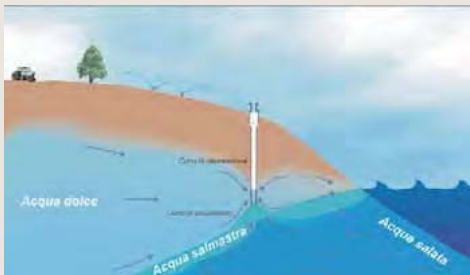
Fig. 3.8 - Il sovrasfruttamento delle falde e/o l'immagazzinamento della risorsa idrica a monte provoca l'abbassamento del livello dell'acqua e la conseguente possibilità di intrusione salina nelle aree costiere. Quando i prelievi delle acque mediante pozzi, captazioni, ecc. sono superiori alla ricarica naturale delle falde acquifere, il livello dell'acqua può scendere drasticamente fino a compromettere la riserva idrica.
