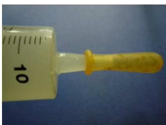
Fig. 8 - Chiusura del puntale con tettarella in silicone
