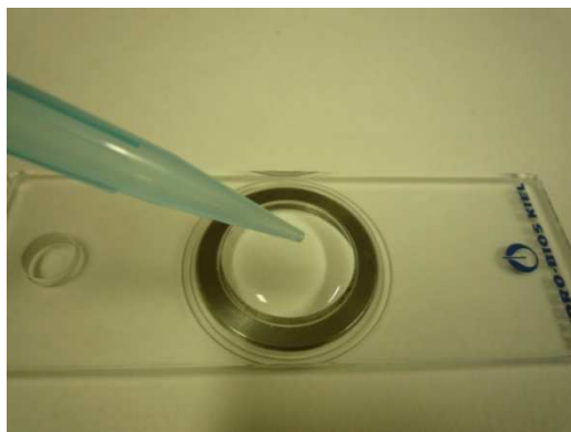
Fig. 10 - Aggiunta di acqua di mare filtrata e formazione di un menisco convesso.
