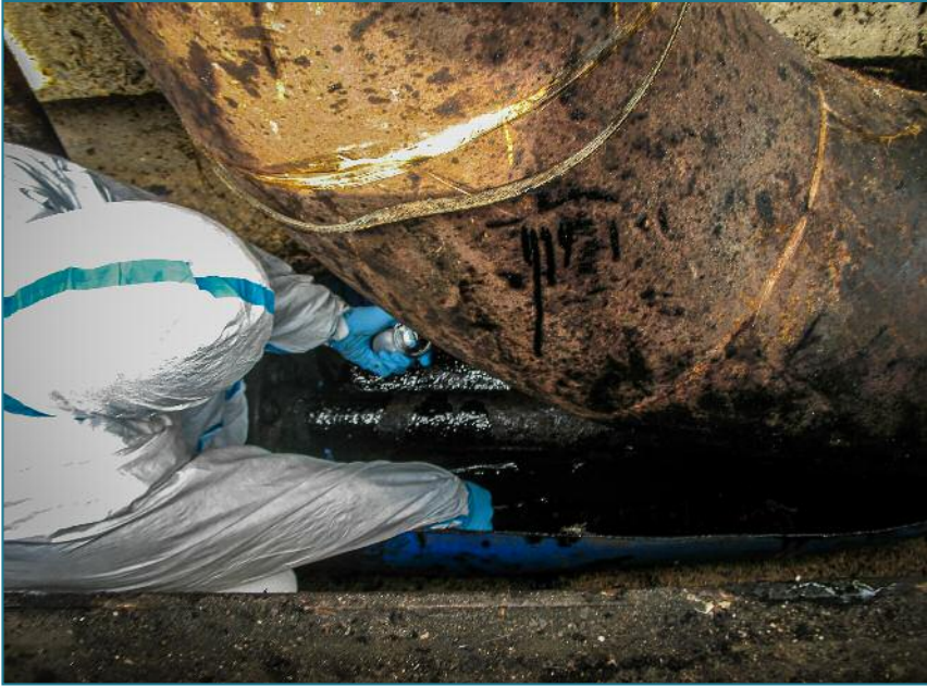
Figura 5 - Campionamento di idrocarburi da una tubatura: l'operatore indossa una tuta tipo tyvek® guanti e respiratore
