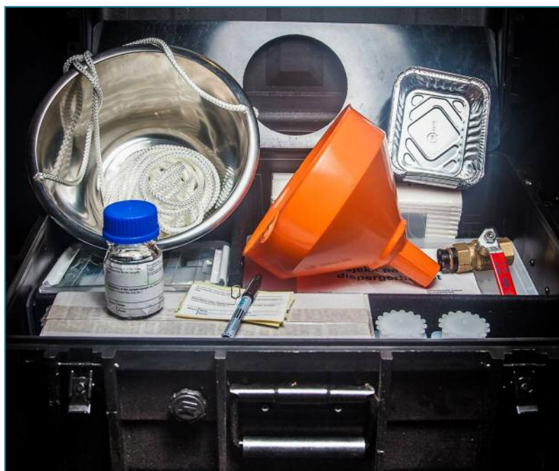
Figura 25 - Materiale per il prelievo di campioni di olio per analisi chimico - fisiche
