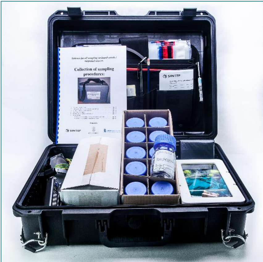
Figura 22 – Kit per il prelievo di campioni a bordo di una nave (fonte Bonn Agreement Guidelines)
