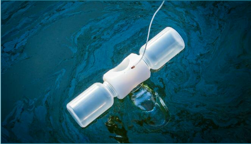
Figura 12 - Campionatore tipo "Schomaker" per il prelievo di strati sottili di idrocarburi e loro iridescenze in due momenti del suo utilizzo: lancio sulla superficie da unità natante (a) e campionamento (b).
