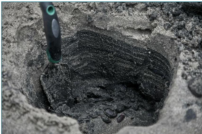
Figura 17 - Sondaggio sub-superficiale su costa sabbiosa
