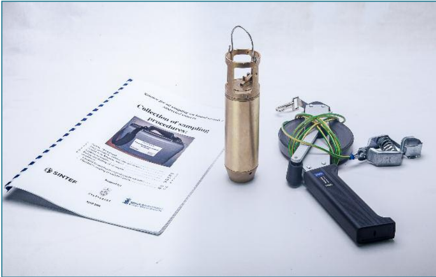
Figura 21 - Strumento idoneo per il prelievo di campioni a bordo di una nave (fonte: Bonn Agreement Guidelines)
