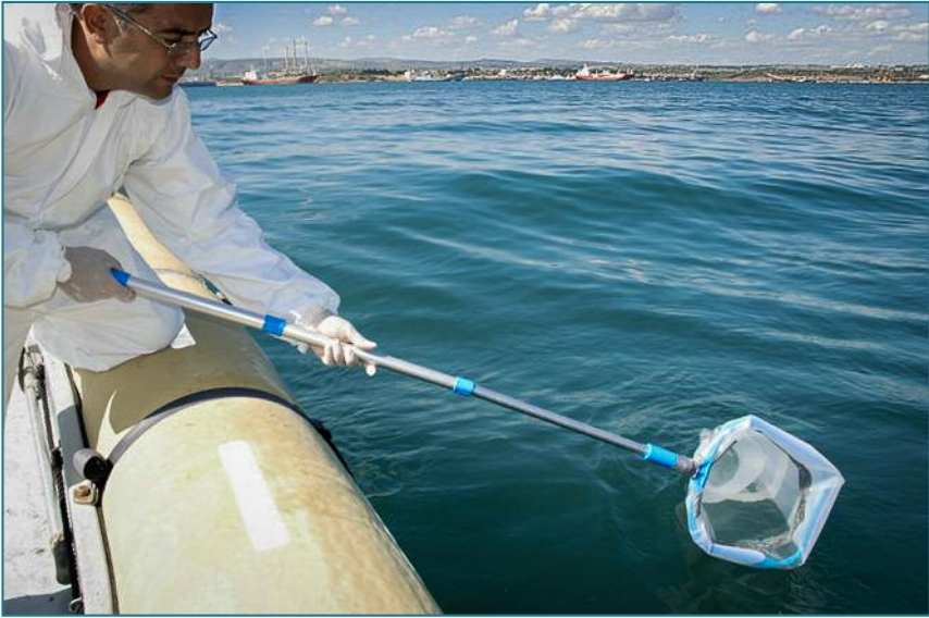
Figura 10 - Campionamento superficiale di idrocarburi con campionatore in Teflon®
