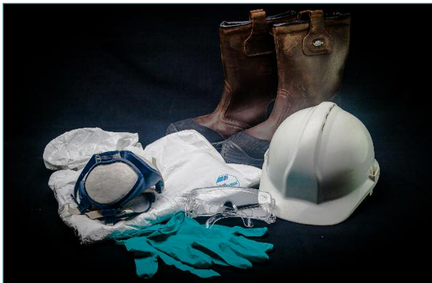
Figura 4 - Principali DPI impiegati per il sopralluogo e il campionamento di versamenti di prodotti petroliferi
