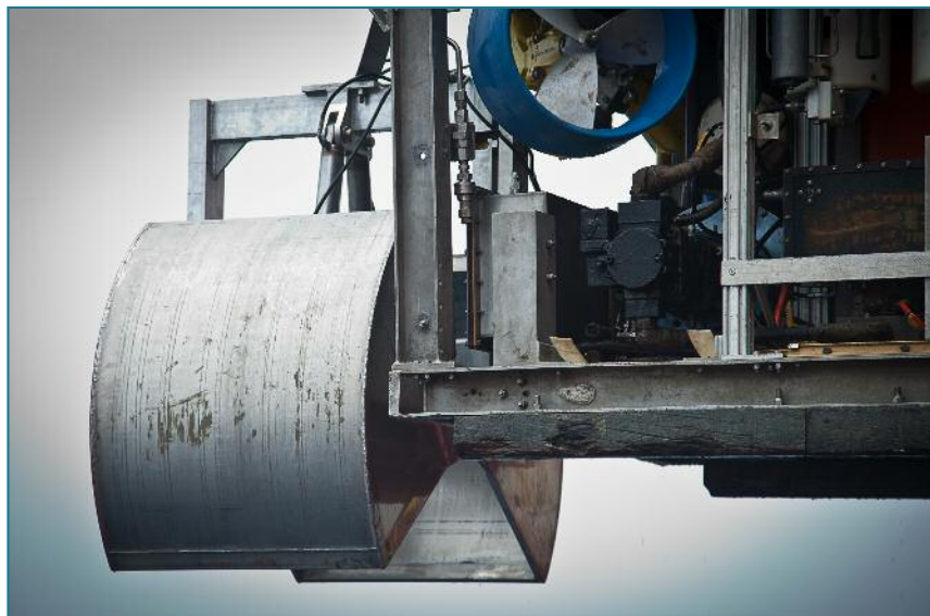
Figura 16 - Dettaglio di una benna montata su un R.O.V. tipo Work class per campionamenti ad elevate profondità
