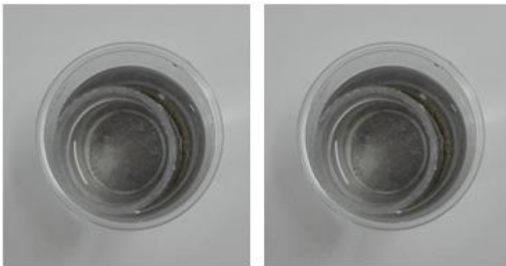
Figura 10: Camera test per il test LDR-S contenente sedimento sul fondo e il tubo di plexiglass con maglia filtrante da 50 \mu m (da Buttino et al., 2018 modificato).
