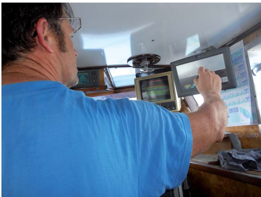
Figura 7.4 - Log-book elettronico utilizzato per l'acquisizione di dati georeferenziati di cattura delle principali specie bersaglio di rapido e strascico a divergenti
