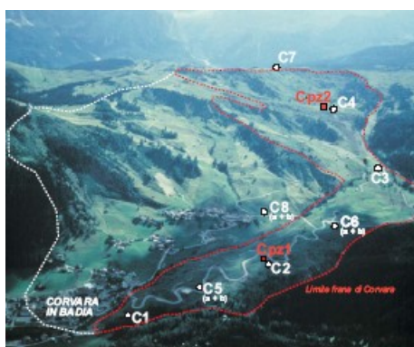
Figura 8.19 a) Ubicazione degli inclinometri (monitoraggio 1997-2001); b) Cartografia della frana con indicazioni morfologiche (S1, S2, S3, S4, T, A).
