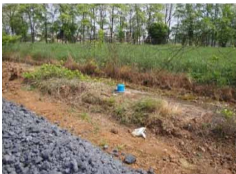
Figura 3.10 - Piezometro GW 3003, designato per l'area di taratura
