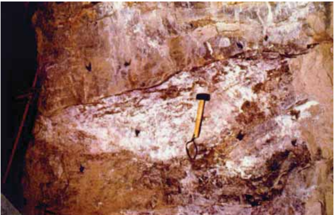
Figura 3. Lente di fluorite su fronte di coltivazione in sotterraneo. Miniera del Laghetto di Polzone.
