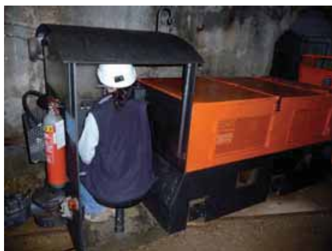
Figura 9. Postazione di guida del locomotore
