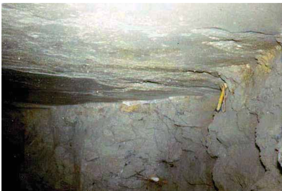
Figura 9. Strutture geologiche: piano di sovrascorrimento suborizzontale che taglia il corpo minerario. Vuoto di coltivazione, Miniera del Laghetto di Polzone.
