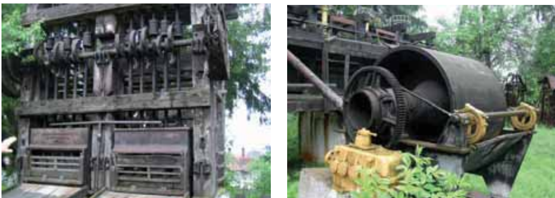
Figura 3. Macchine a vapore per macinare il grezzo, esposte a cielo aperto, presso le gallerie di età romana della miniera aurifera di Alburnus Maior (Rosia Montana, distretto di Alba)
