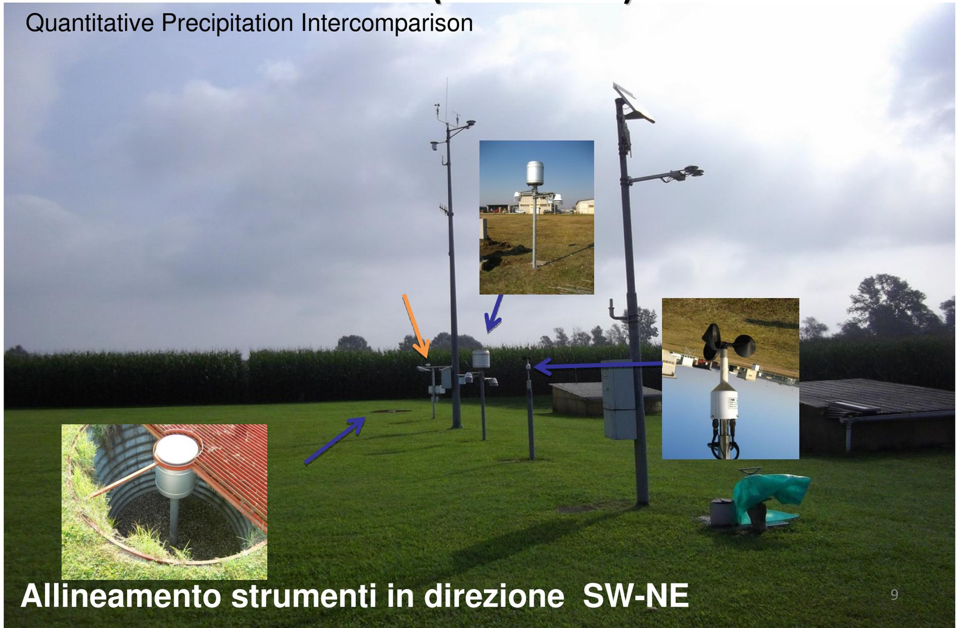
**Allineamento strumenti in direzione SW-NE**
