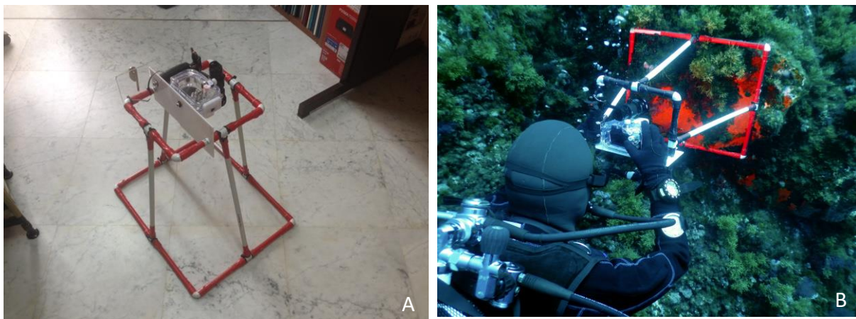
Figura 3.1 – Esempio di frame in pvc con superficie e distanziatore fissi (A) e utilizzo in campo (B)
