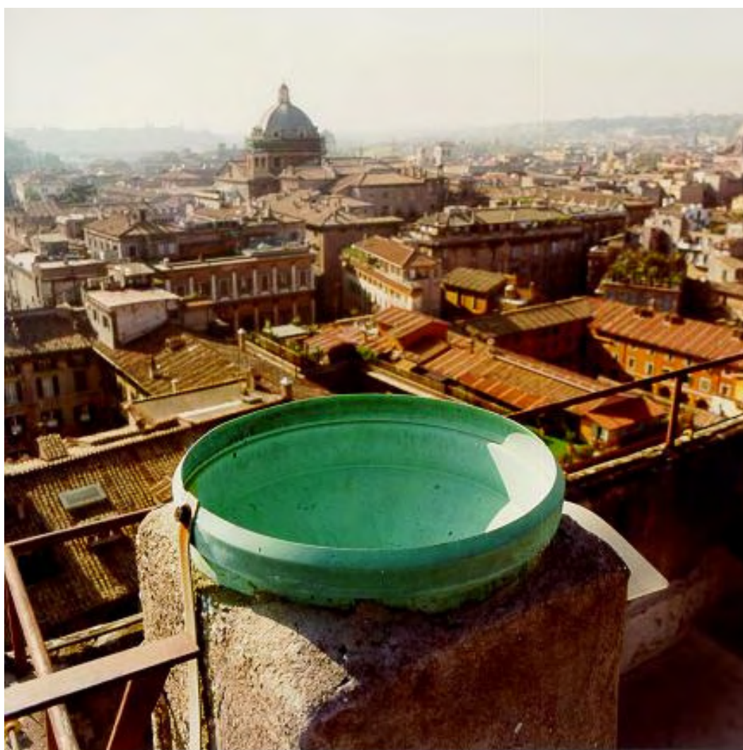
Fig. 3 - Bocca tarata del pluviografo all'Osservatorio del Collegio Romano. - Rain collector of the meteorological observatory Collegio Romano.
