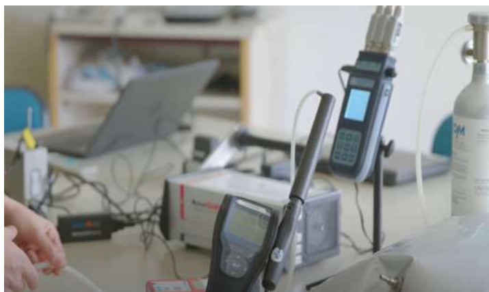
Fig. 5 – Strumentazione per la misura della CO 2 e del radon in continuo.
