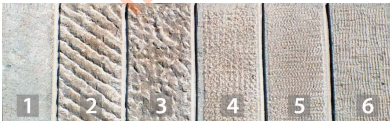
Fig. 5 - Alcuni tipi di lavorazione della pietra di Viggiù: 1) lavorazione con lo scalpello; 2) lavorazione con la punta da cava; 3) lavorazione con punta; 4) lavorazione con bocciarda; 5) lavorazione con martellina; 6) lavorazione a gradina. Immagine tratta dal sito www.museiciviviciggiutesi.com - Some types of Viggiù stone processing: 1) stone worked with plain chisel; 2) with metal quarry point; 3) with metal point; 4) with bush-hammer (bocciarda); 5) with toothed stone hammer (martellina); 6) with tooth chisel (gradina). From www.museiciviviciggiutesi.com .
