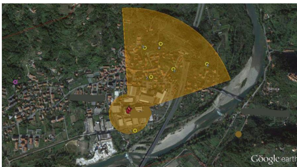
Figura 2.4 - Punti di campionamento per la verifica delle ricadute al suolo delle sostanze disperse in atmosfera a seguito di incendio
