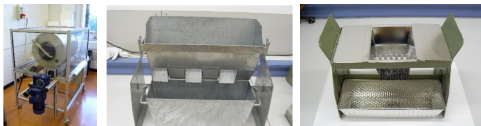
Fig 3.2- Sistema per la miscelazione e l'omogeneizzazione del campione (a sinistra). Ripartitore manuale RETSCH RT 75 (al centro) e RETSCH RT 6.5 (a destra)
