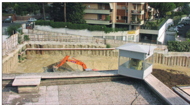
Fig.5 - Stazione Totale: lo strumento è protetto all'interno di un box e posizionato su un edificio stabile prossimo al cantiere.
